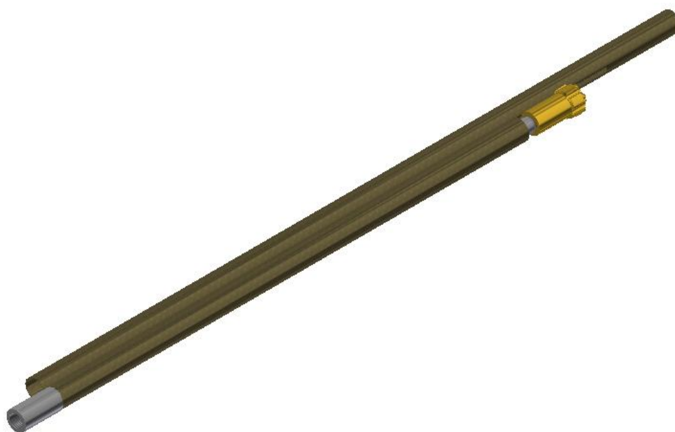
Рисунок 3.12 - Приспособление для бурения основной скважины и параллельно-сопряженных скважин диаметром 65мм
