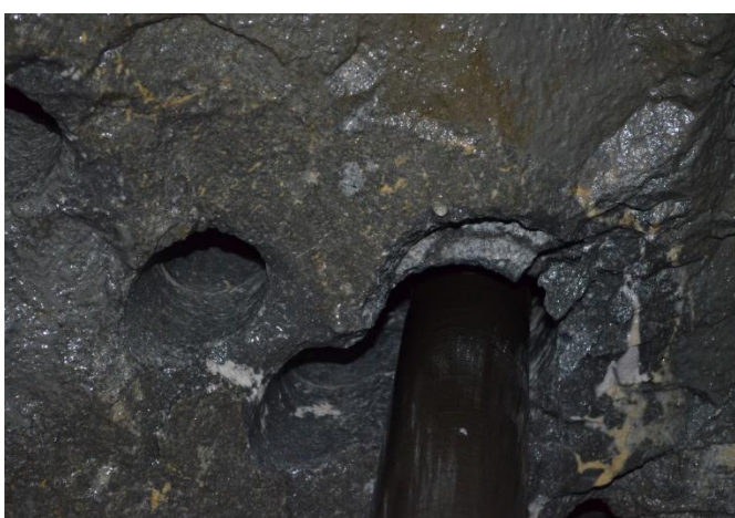
Рисунок 3.8 – Способ образования врубовой полости с применением устройства для бурения параллельно-сопряженных скважин диаметром 65 мм и 110 мм
