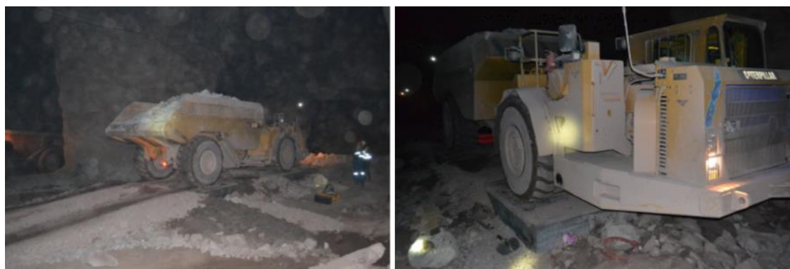
Рисунок 3.14 - Процесс взвешивания подземного самосвала CAT AD30 в подземных условиях.
