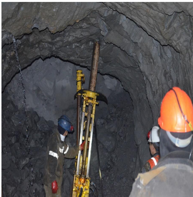
Рисунок 3.7 – Приспособление для бурения параллельно-сопряженных скважин диаметром 65мм и 110мм показано в момент установки на предварительно обуренную скважину
